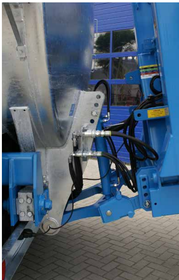
Geïntegreerde, zware hefinrichting met pendelfunctie.
