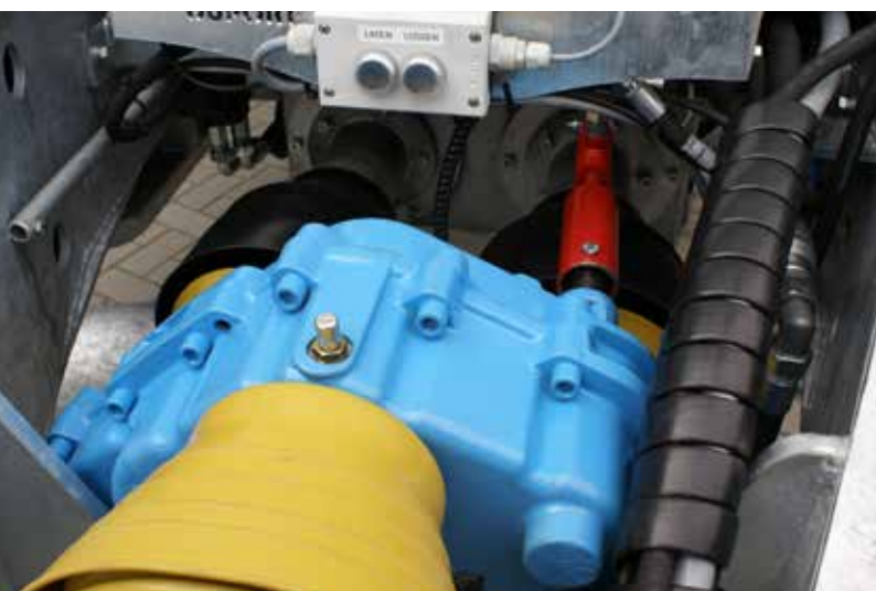
Duport aandrijfkast met de mogelijkheid om met 1 of 2 pompen te bemesten.
