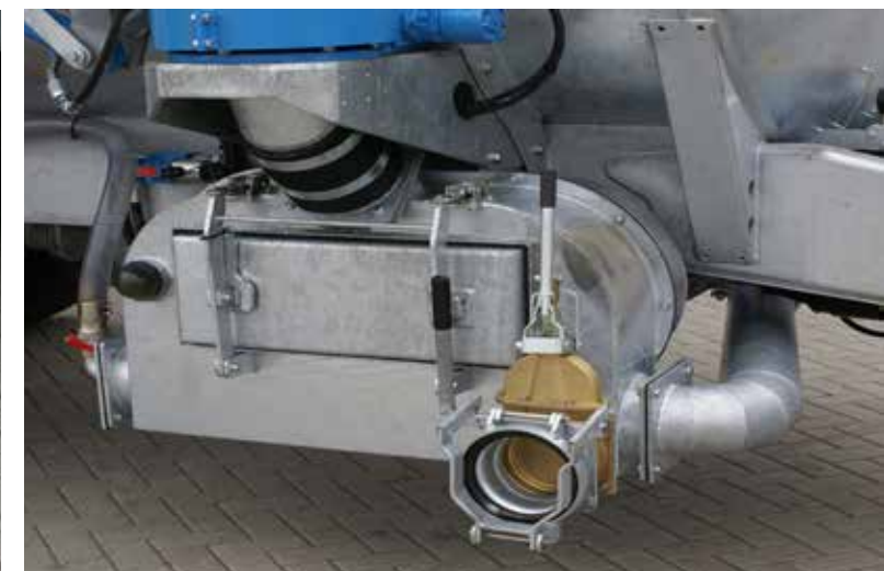
Duport snijfilter L-20000, gecombineerd met de 6" zijaansluiting.
