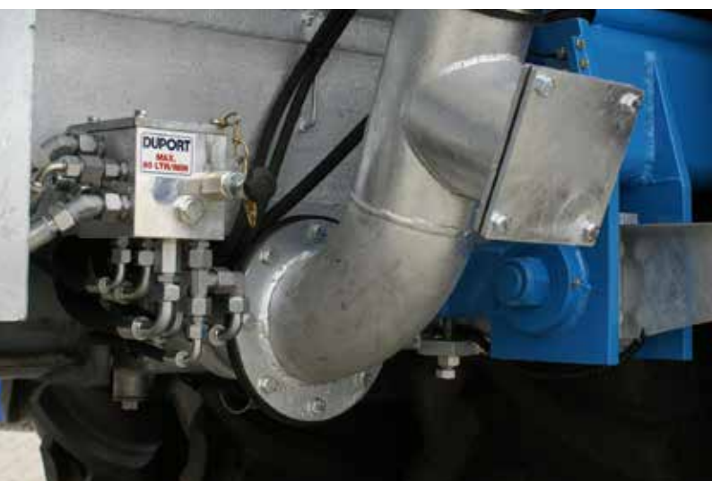
Duport volgordeventiel met ingebouwde mogelijkheid voor zweefstand.
